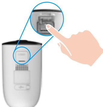
Si la caméra n'a plus de batterie, connectez-la à une prise de courant avec l'adaptateur d'alimentation pour le charger (5 V; 2 A).
